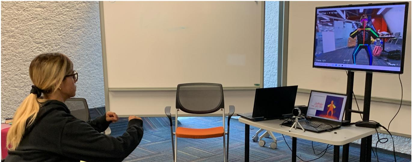
Fig. 4: Ejemplo de configuración propuesta con base en dispositivos y herramientas tecnológicas implementadas. Para la fotografía presentada, el sujeto se encuentra realizando pruebas DVJ, adicionalmente, recibe una constante retroalimentación en tiempo real sobre sus puntos clave (pantalla), profundidad (laptop) y media de ángulo de flexión de rodilla (laptop).
